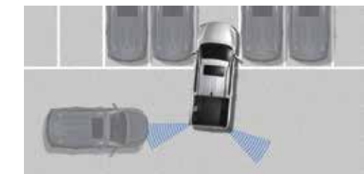
Hátó keresztforgalom-felügyelő (RCTA) A hátul oldalról közeledő járműveket észlelő rendszer segít a tolatási manőver biztonságos végrehajtásában.
