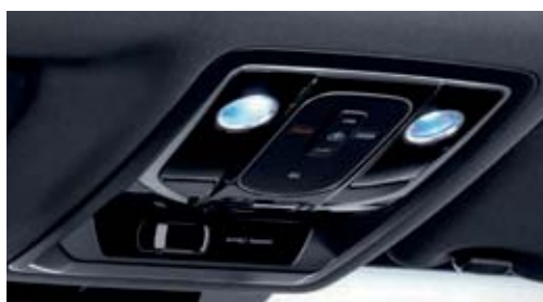
Tetőkonzol, érintésvezérelt beltéri világítás, biztonsági öv figyelmeztetés
