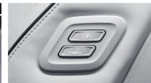
Kiegészítő kapcsoló az utasoldali ülés állításához
