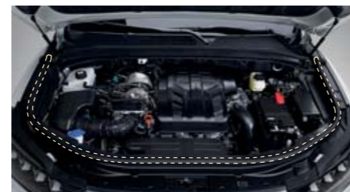
Motortér felső szigetelés
