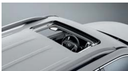
Napfénytető becsípődésgátló funkcióval
