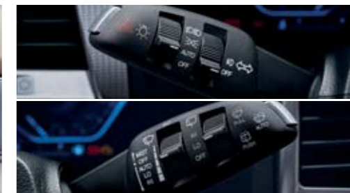
Fényszóró és ablaktörlő vezérlés, automata funkcióval
