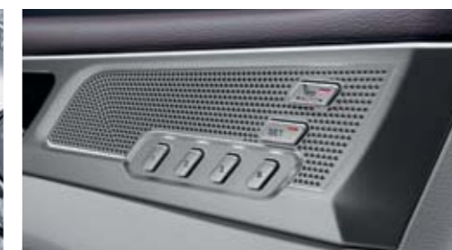
Vezetőoldali ülésmemória, ki-, -beszállást megkönnyítő vezetőülés-mozgatás
