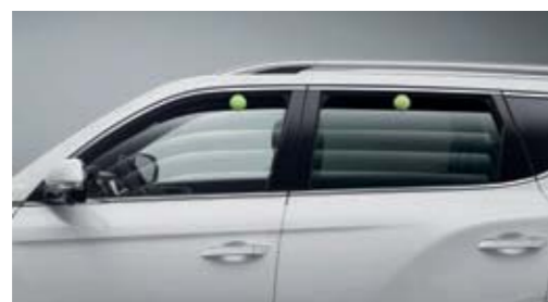
Elektromos ablakemelő becsípődésvédelem funkcióval
