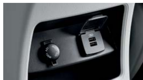
12V-os aljzat és 2 db USB aljzat
