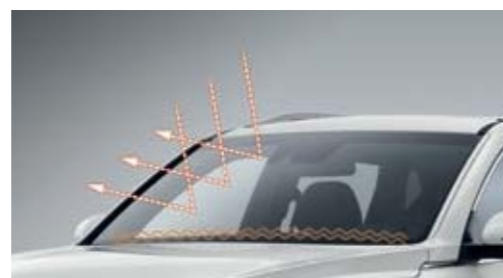
Szélvédő hő- és zajszigeteléssel
